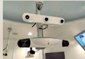
▲ 天井設置の高精度光学カメラでリアルタイムに患者体表面を認識
